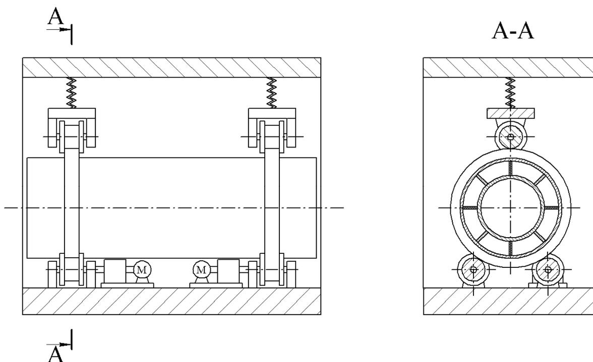
Рис. 1. – Установка для сушки лесоматериалов
