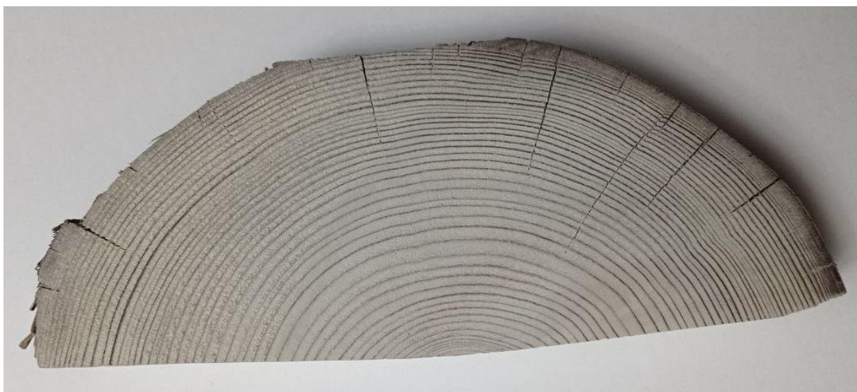
Рис. 2. Трещины периферийной части бревна
