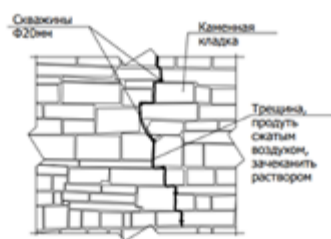
Рис. 6 - Деталь инъектирования трещин
