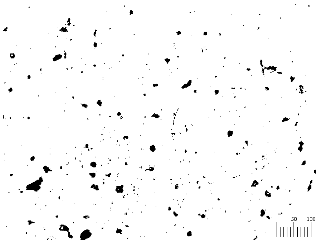
Рис. 1 - Частицы строительной пыли в жилом помещении дома расположенном в 110 м от строительной площадки.
