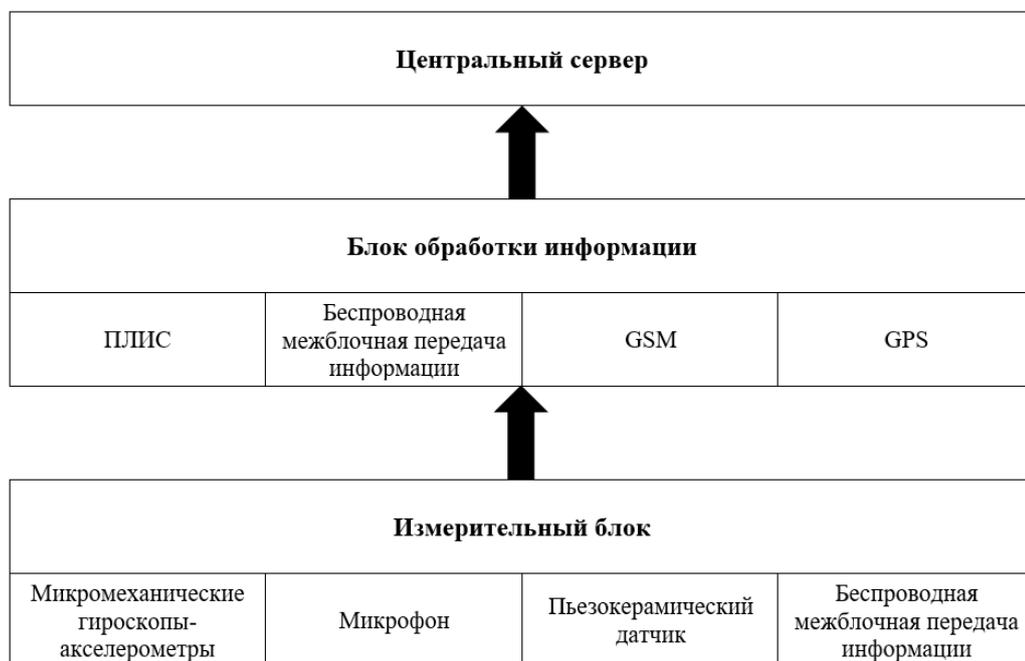
Рис. 3. Блок-схема измерительного комплекса
