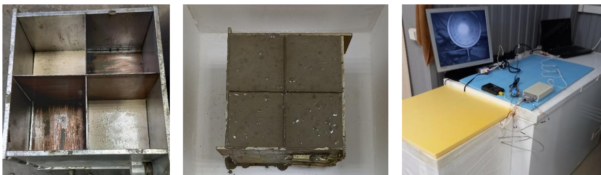
Рис. 1. - Слева направо: форма ФК 200 со вставками, форма с СУБ в термосе, автоматизированный стенд измерения температуры и деформаций бетона в процессе твердения в термосе
