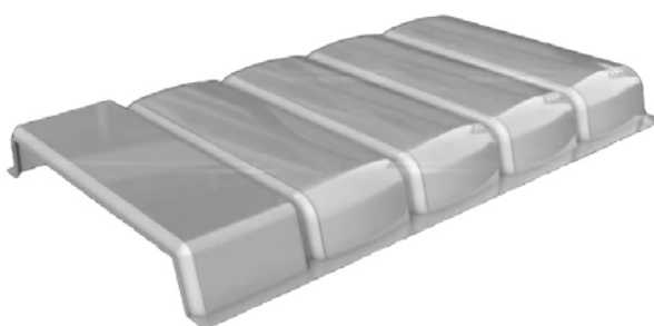
Рис. 1. - Форма для отливки рельефных стеновых панелей.
