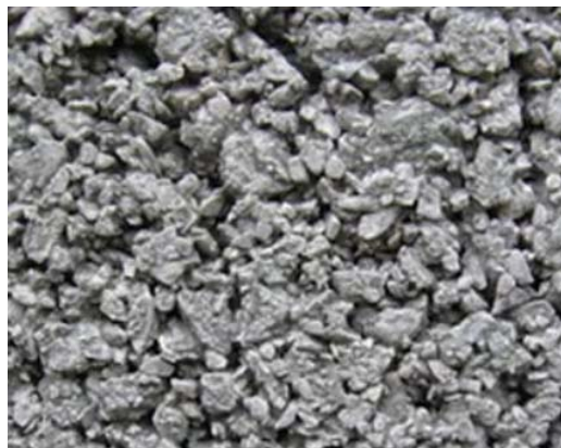
Рис. 1. – Общий вид структуры пористого бетона
