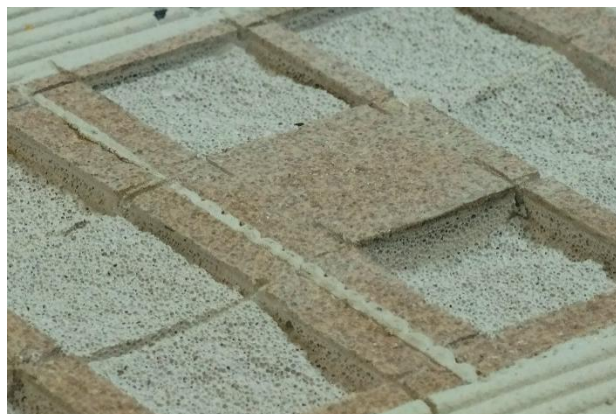
Рис. 1. – Определение прочности сцепления модифицированного строительного раствора с газобетоном
