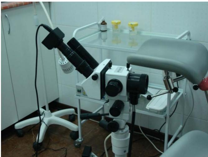
Рис.1. – Кольпоскоп КС-013ДМ с цифровым видеоокуляром ДСМ-310
