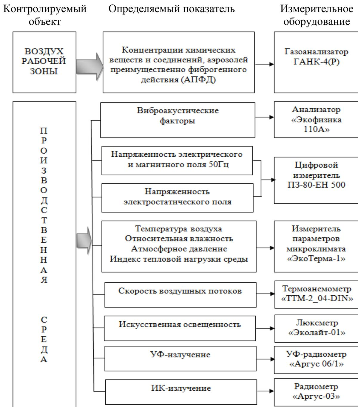
Рис. 4 – Приборное обеспечение работ по специальной оценке условий на рабочих местах предприятий машиностроения
