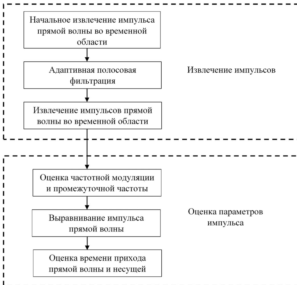
Рис. 2. – Блок-схема оценки параметров прямой формы сигнала
