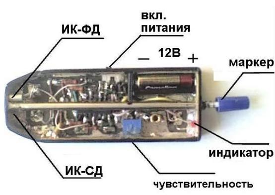
Рис. 1. Внешний вид устройства со снятой крышкой корпуса.
