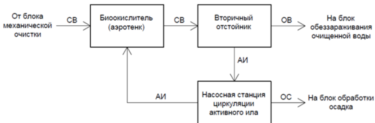
Рис. 2. Блок-схема биологической очистки сточных вод
