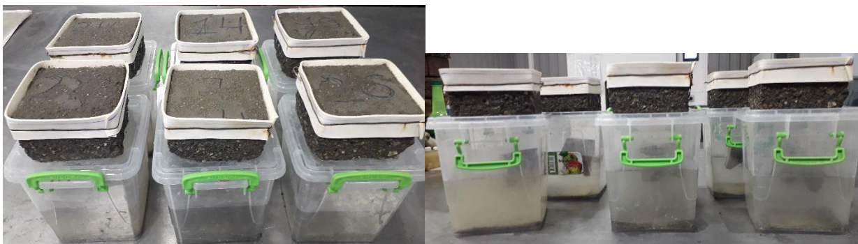
Рис. 1. – Вид образцов ПБТ 1 группы 1 после 15 циклов испытаний на морозостойкость
