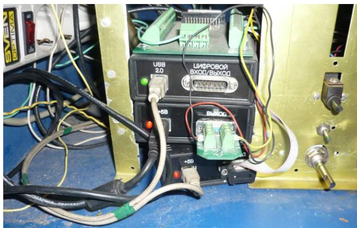
Рис. 3. – Двухканальный усилитель и аналого-цифровой преобразователь
