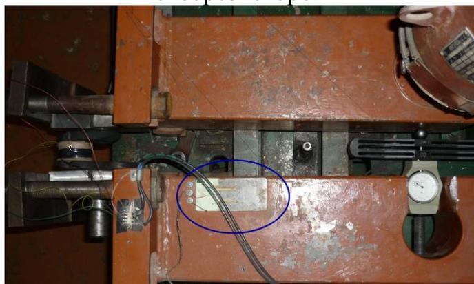
Монтаж балансировочных тензорезисторов
