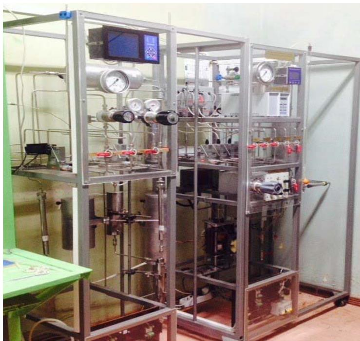
Рис. 1. – Полноциклового пилотный комплекс конверсии природных и попутных нефтяных газов в синтетические углеводороды по методу Фишера-Тропша
