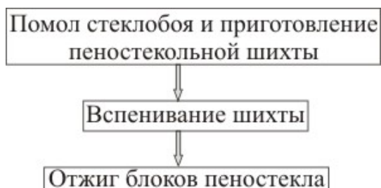
Рис.1. – Основные технологические операции получения пеностекла
