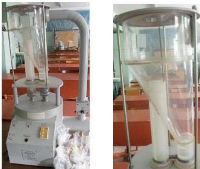
Рис. 3. Классификатор лабораторный марки У21-ЛПК
