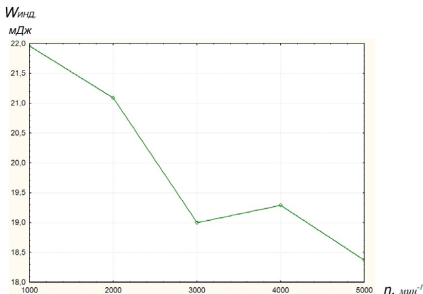
Рис. 2 – Энергия  $W_{\text{ир}}$ , выделяемая в межэлектродном зазоре свечи зажигания индуктивной фазой ТрСЗ на холостом ходу в зависимости от частоты вращения  $n$  коленчатого вала двигателя
