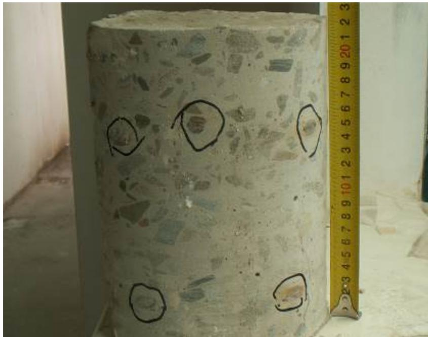
Рис. 1. Керн из плиты перекрытия одного из обследованных зданий
