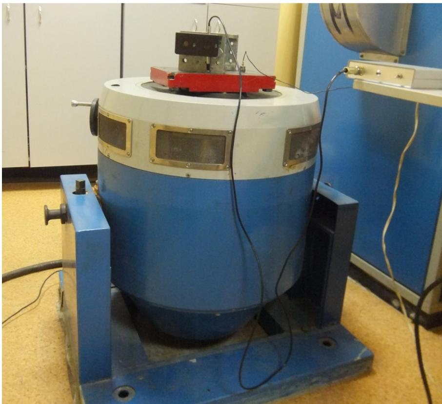
Рис. 1 – Расположение датчика LVDT на вибростенде ВЭДС-040.
