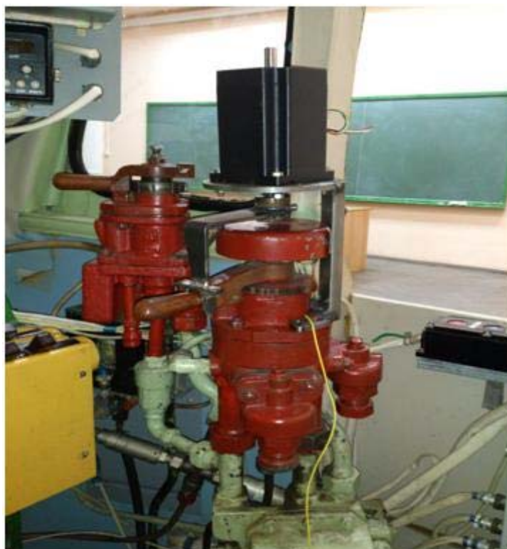
Рис. 2 – Механическое устройство для управления краном машиниста
