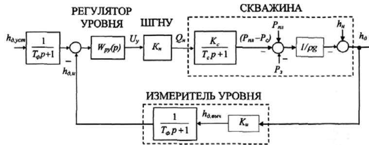
Рис. 1—Структурная схема системы автоматического регулирования динамического уровня
