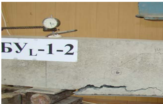
Рис.2. – Виды и формы разрушения опытных образцов
